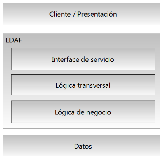
Figura 13: Estructura de capas propuesta por EDAF
