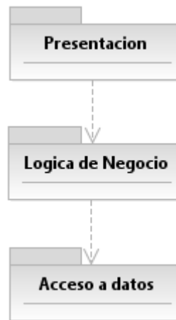
Figura 10: Estructura genérica en capas de AE
